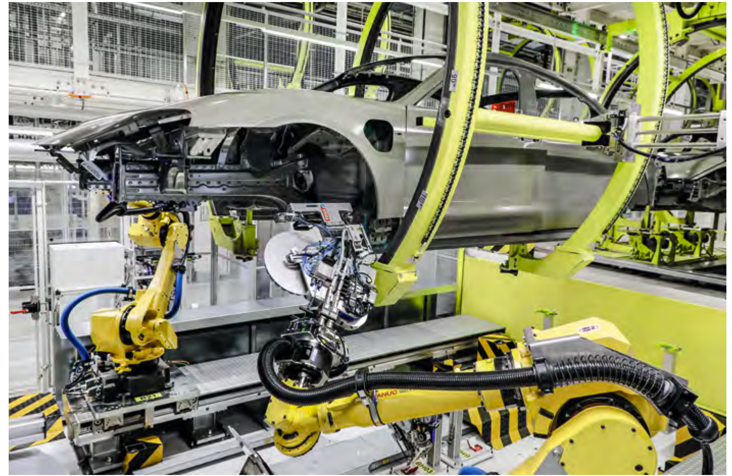
NEUES FERTIGUNGSVERFAHREN SETZT AUF KLEBEPADS STATT KUNSTSTOFF-STOPFEN
